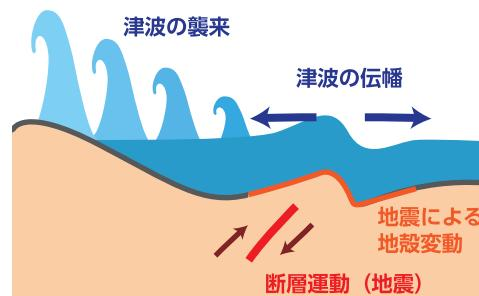
海底下で大きな地震が発生すると、海底に上下方向のずれが現れます。このとき海面が大きく動いて、大きな波となって四方八方に伝わるもののが津波といいます。
