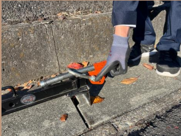
① 安全装置を外します (左写真：解除前 右写真：解除後)
