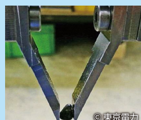
燃料デブリをつかむ先端治具（グリッパ型）
