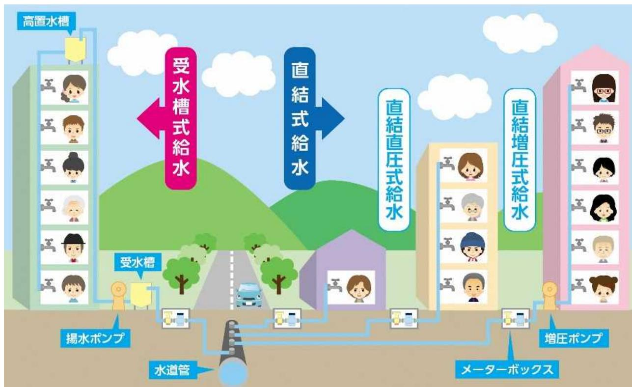
〈直結式給水と受水槽式給水のしくみ〉
