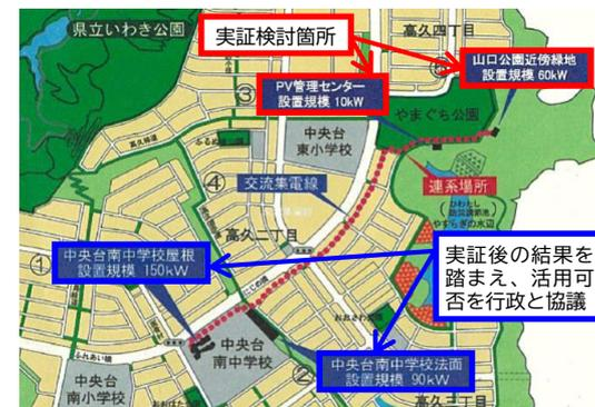
図 太陽光発電集中連系システム配置図
