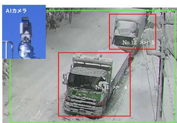
AIカメラによる車両滞留の自動検知システム
