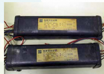
照明器具の安定器
