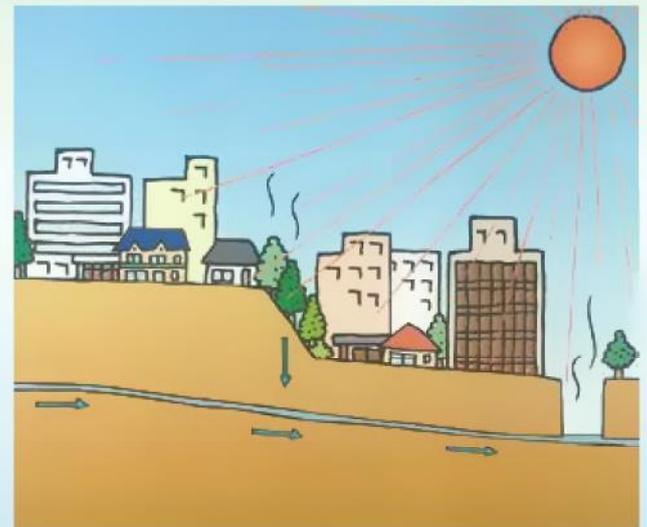
都市化に伴い、雨水の地下に浸透する面積が減少し、浸み込みにくくなったため、少しの雨でも直接川へ流れこんでしまい、水があふれやすくなっています。
