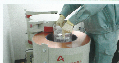
ゲルマニウム半導体検出器 放射性物質の種類と量を検査します。
