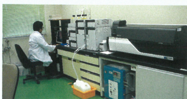
液体クロマトグラフ質量分析装置 有害成分を検査します。
