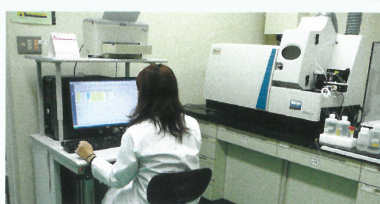
誘導結合プラズマ質量分析装置 金属類を検査します。
