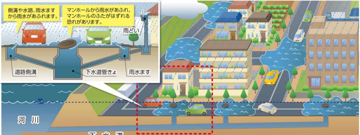
大雨が降り、下水道や道路側溝などで排水能力を超えると、道路冠水などの浸水が起り始めます。
