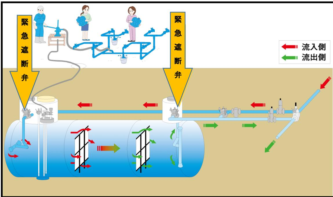
通常時は管路として機能するが、災害その他の事故による漏水が発生した場合は、漏水による周辺管路の水圧低下を感知して前後に設置されている緊急遮断弁が作動し飲料水を確保する。
