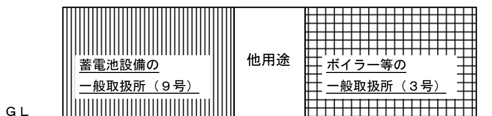
第4-1図 建物内に2つの区画室単位の一般取扱所を設置した例
