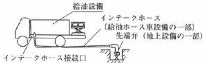
第10-53図 給油ホース車インテークホースの例
