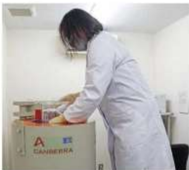
ゲルマニウム半導体検出器 放射性物質の種類と量を検査
