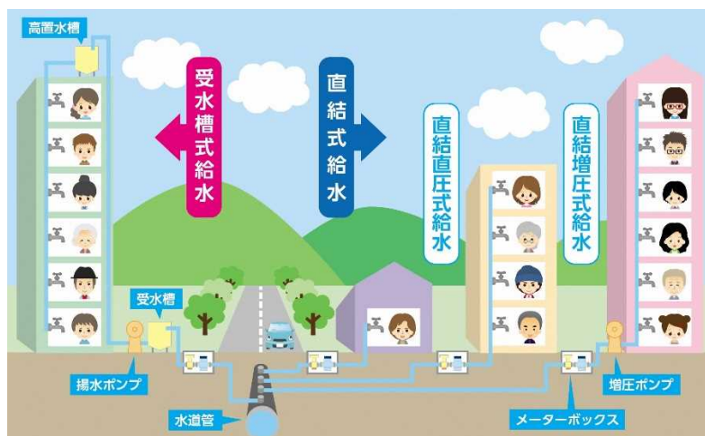
図 67 直結式給水と受水槽式給水のしくみ
