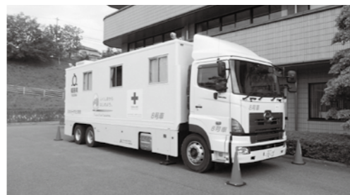
ホールボディカウンターを搭載した検査車両
