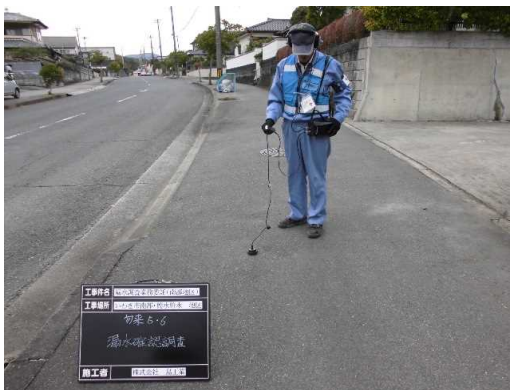
漏水調査の様子①（路面音聴調査）
