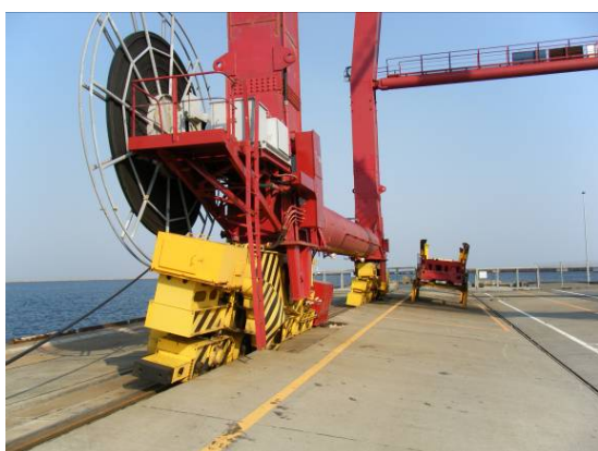
ガントリークレーン
