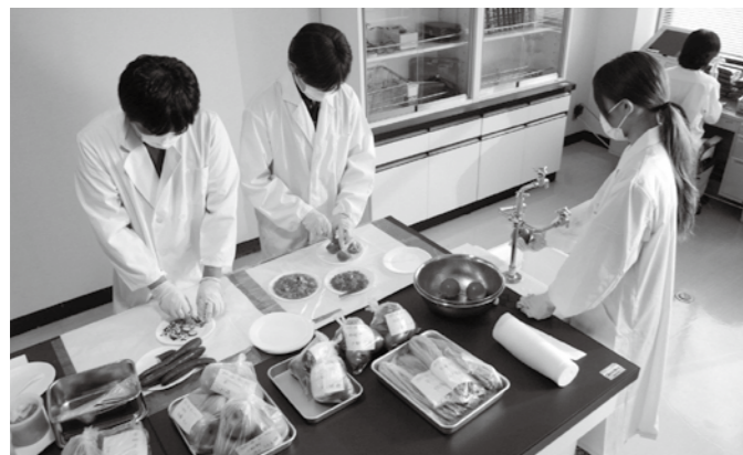
洗浄・細断などの前処理をして専用の機械で放射性物質を測定し、インターネットで結果を公開
