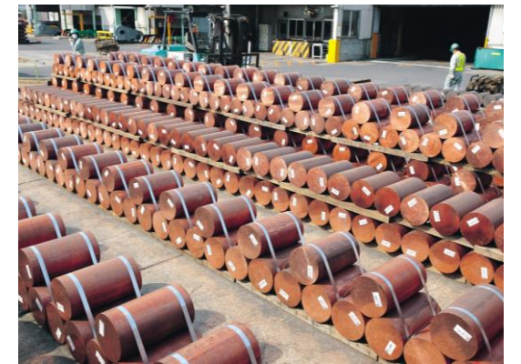
【電気銅や銅スクラップを溶解し、鑄造して生産されるピレット（銅管、銅棒等の原料）】
