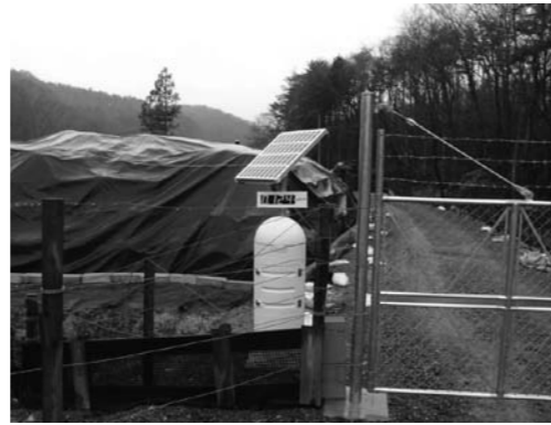
仮置場に「リアルタイム線量測定システム」を設置し安全性を確認
