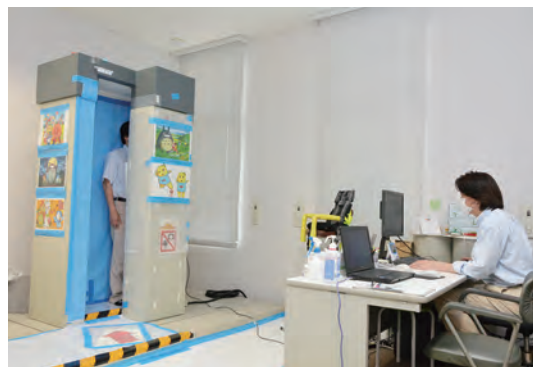
■写真6-(4)-1 ホールボディカウンターによる内部被ばく検査〔平成26(2014)年6月 いわき市撮影〕
