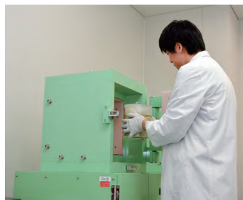
■写真6-(4)-2 ゲルマニウム半導体検出器による食品等の放射性物質検査（平成26(2014)年6月いわき市撮影）
