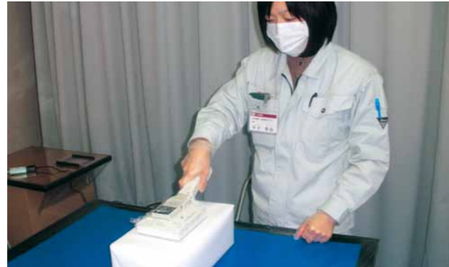
市環境監視センターにおいて工業製品の残留放射線を測定
